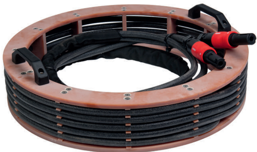
📌 6 Εύκαμπτος επαγωγέας σε βοηθητικό πλαίσιο
