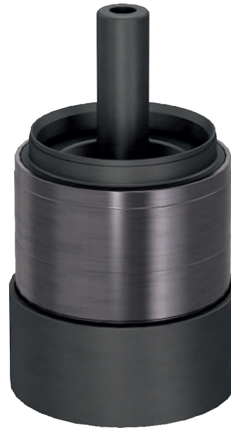
8 Příklad ložiska v nástroji pro těsnicí krytky
