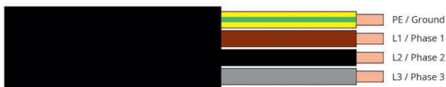
32 Realizați conexiunea la rețea în 3 faze și cu împământare
