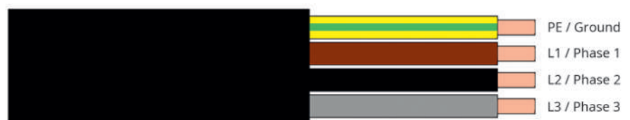
32 Nodrošiniet tīkla pieslēgumu ar 3 fāzēm un zemējumu
