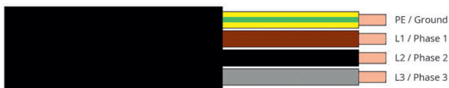
32 Prijunkite tinklo jungtį per 3 fazes ir įžeminimą
