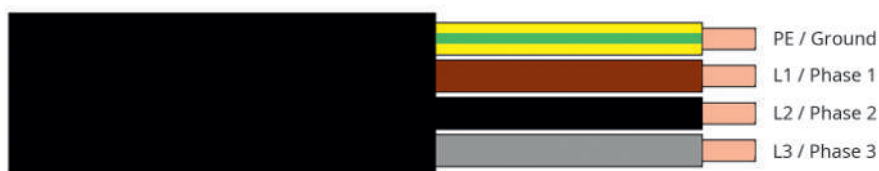
32 Verkkoon liittäminen 3 vaiheella ja suojamaadoituksella
