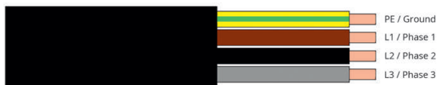
32 Tilslut strømforsyningen med 3 faser og jord
