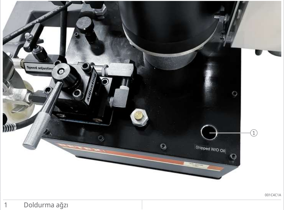
5 Pompa akümülatörünün doldurma ağzını açın
