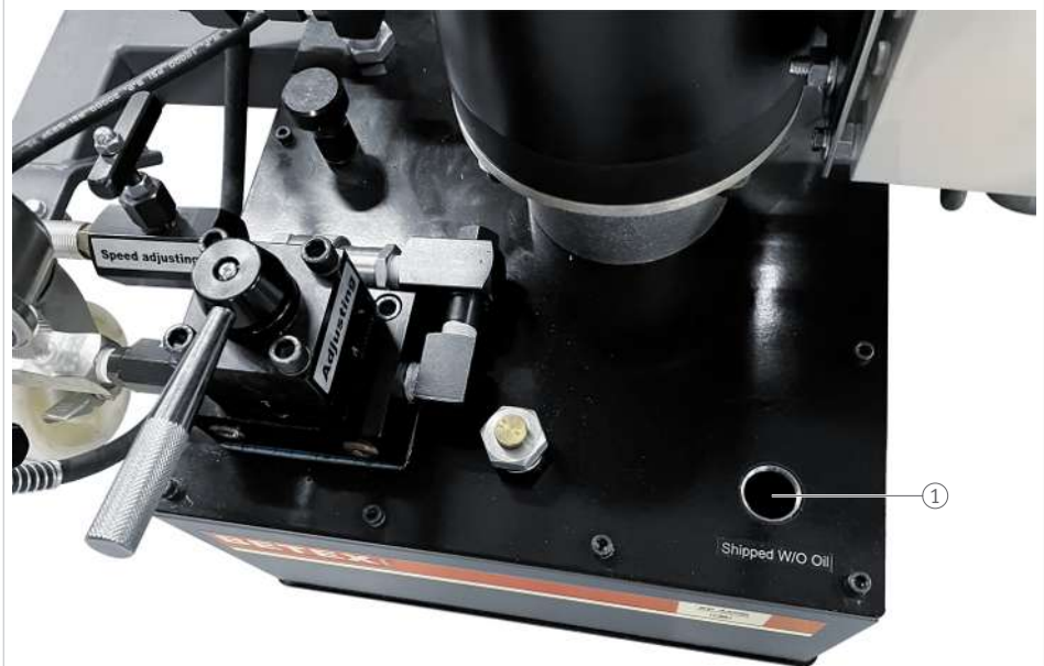
☞ 5 Άνοιγμα στομίου πλήρωσης του δοχείου αντλίας
