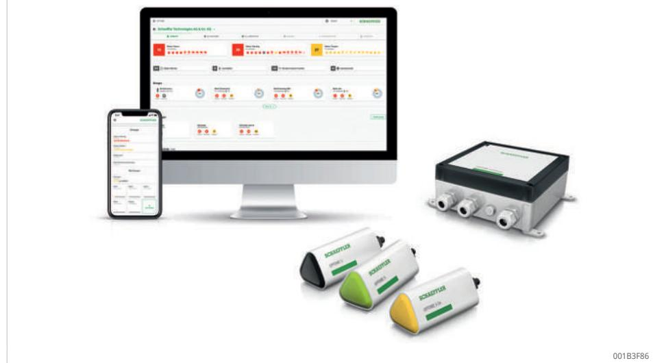
Os sensores e lubrificadores da Schaeffler OPTIME formam automaticamente uma rede de malha que transmite dados diretamente ou através de outros sensores ao gateway OPTIME. Na rede, os sensores transmitem dados brutos de vibração e valores característicos (KPI) pelo gateway OPTIME para a nuvemOPTIME. Ali é realizada a análise de dados, e os resultados dessa análise são enviados ao Web App OPTIME e ao OPTIME Mobile App. Todas as análises
