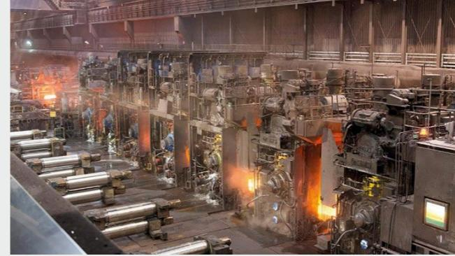
极端压力、高温、持续的水接触以及外来物影响：位于蒂森克虏伯钢铁欧洲公司波鸿工厂的宽带热轧机中的滚动轴承必须承受巨大的负荷。因此，该德国领先的优质钢铁产品供应商选择了由碳氮共渗处理的Mancodur制造的圆锥滚子轴承，这些轴承特别耐磨损和耐高温。此外，舍弗勒的专家已经在远程诊断中心对设备进行了长达十年的监控，并将可能的轴承损伤立即报告给蒂森克虏伯维护团队。
