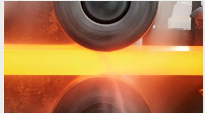
德国锡根的VDM Metals GmbH公司进行了轧机技术改造，升级为能够承受最大60兆牛轧制力的最先进型号，并集成液压调节和工作辊弯曲功能。客户要求尽可能多地重复使用现有组件，这部分是通过对现有轴承进行镀铬以达到新直径来实现的。一个特殊的四列圆柱滚子轴承，具有较大的内径和一体钢保持架，使得升级至更高轧制力成为可能。
