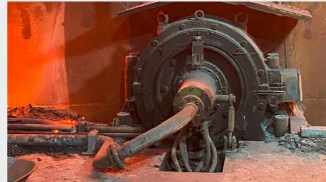
如果钢厂中的转炉出现故障，损失可能高达数百万欧元。防止计划外停机需要一个综合解决方案。ProLink CMS振动监测系统提供了基础监测，并且可以通过传感器进行扩展，包括声发射、偏转、负载以及使用GreaseCheck进行润滑脂监测。获取的数据由舍弗勒的专家通过远程诊断在德国在线监测中心(OMC) 进行评估。
