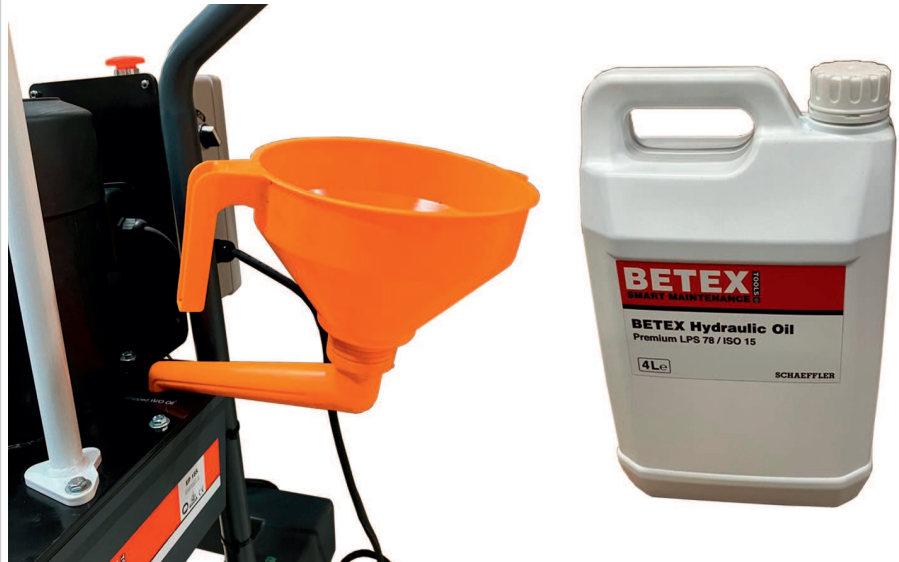
图5 加注泵储油罐
