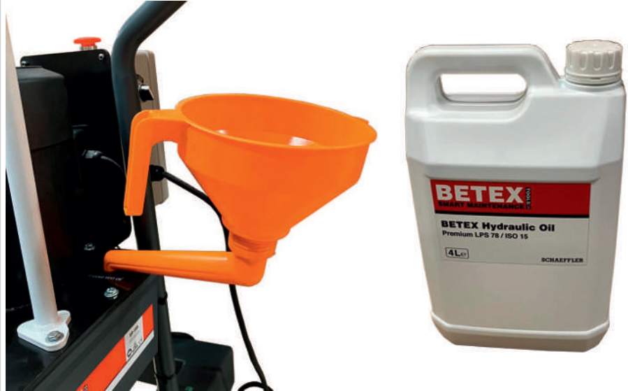
5 Pompa akümülatörünün doldurulması
