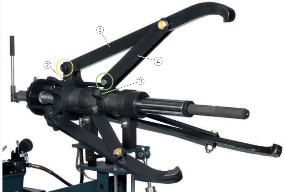
7 Kolların montajı ve sökülmesi için parçalar
