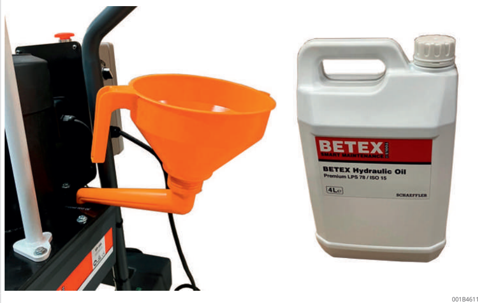
5 Umplerea rezervorului pompei
