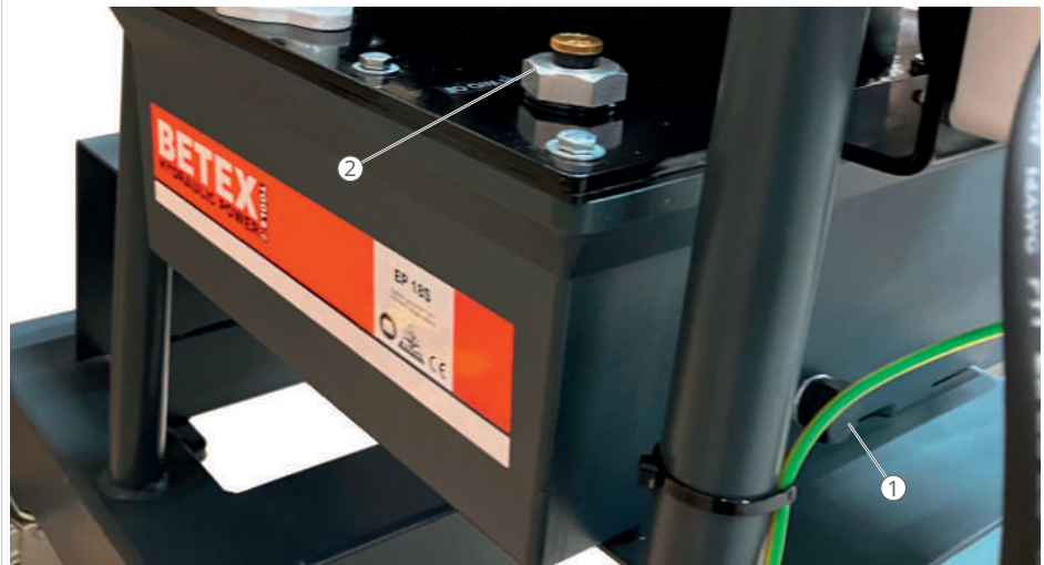
12 Acumulador da bomba
