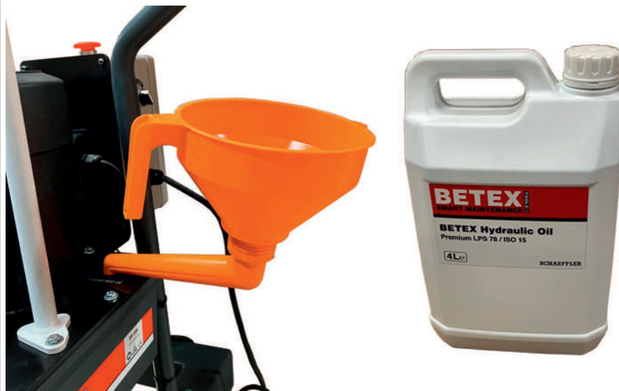
5 Napełnianie zbiornika pompy
