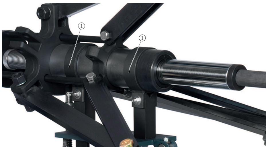
図8 中心軸を中心にプラーを回転させる
