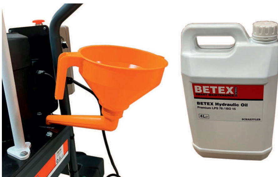
5 Riempimento dell'accumulatore della pompa
