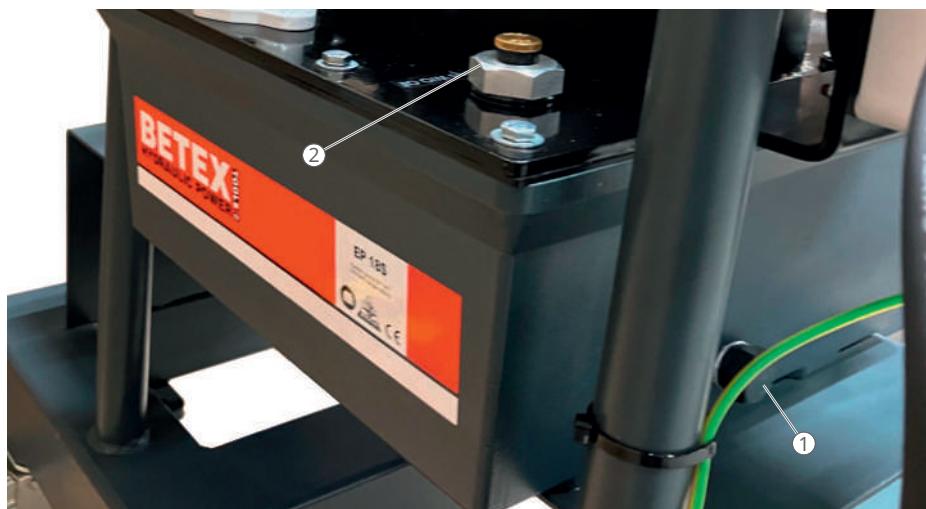
12 A szivattyú nyomástárolója
