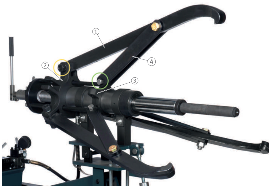
7 Composants pour le montage et le démontage des bras
