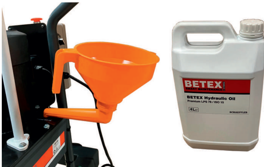
⑤ Remplissage de l'accumulateur de pompe
