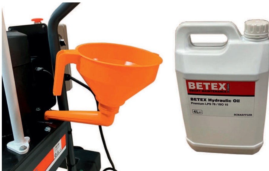
5 Opfyldning af pumpeakkumulatoren
