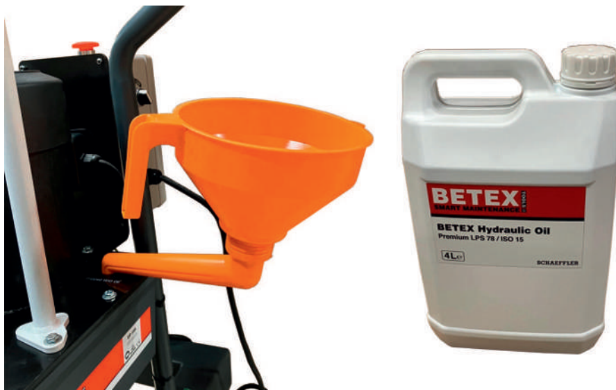
5 Plnění nádrže čerpadla
