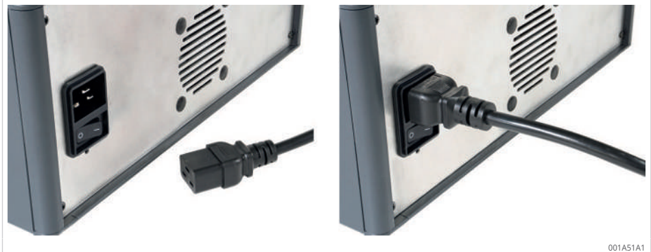
図37 電源接続ケーブルの接続
