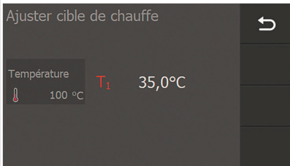
34 Exemple de cible de chauffage
