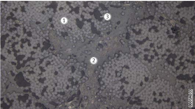
图 1 ELGOTEX-WA 纤维缠绕衬套的滑动层 微观截面
