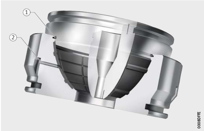
① 密封 ② 润滑孔 图 4 接触面为硬铬 / GFRP 的轴向推力关节轴承
